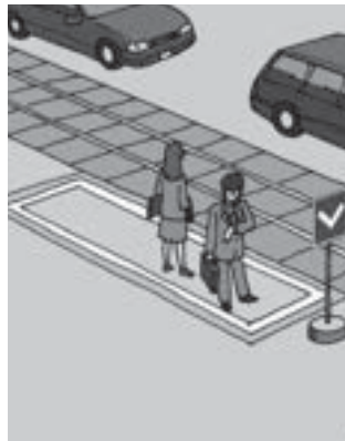
Zona de segurança indicada por sinalização e marcações de solo
